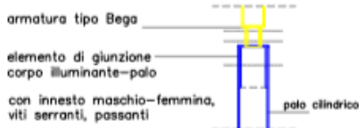
PARTICOLARE INNESTO ARMATURA TESTA PALO
